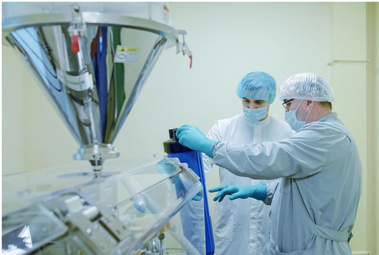
RT-110 горизонтальная автоматическая упаковочная машина в САШЕ. Класс чистоты Д
