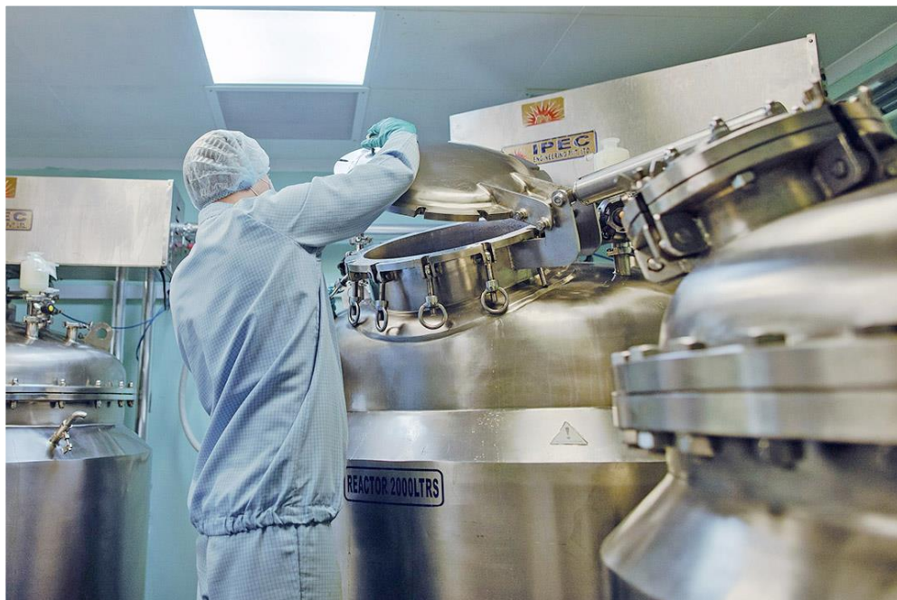
Реакторы для приготовления растворов. Класс чистоты С
