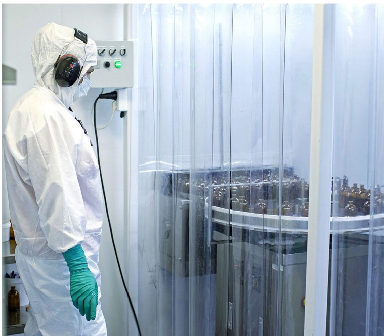
Выход стерильных флаконов из депирогенизационного туннеля. Локальная зона А
