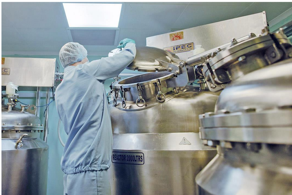
Реакторы для приготовления растворов. Класс чистоты С
