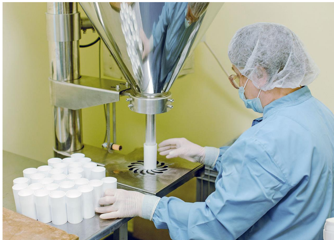
Процесс фасовки лекарственного препарата. Класс чистоты Д
